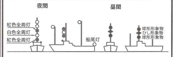
図-8 浚渫船「海翔丸」の灯火及び形象物
