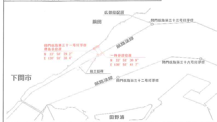
図-1 関門航路第三十一号灯浮標一時移設・復旧
