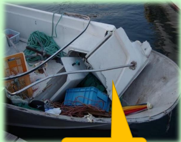
衝突により船首が破損したA丸網
