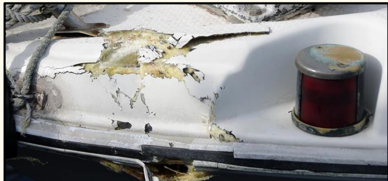
船首部を損傷したプレジャーボート
