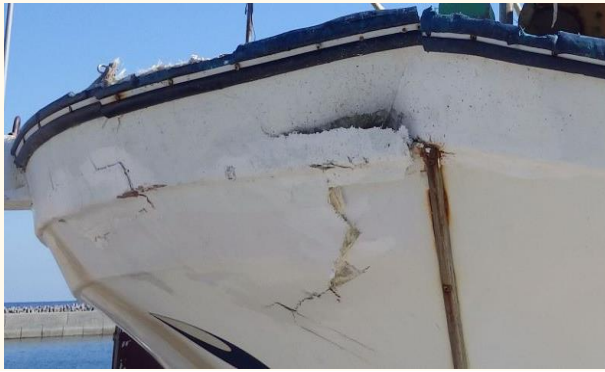
船首部を損傷したプレジャーボート
