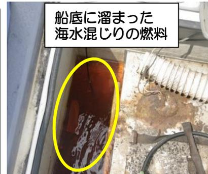
ビルジ量確認の他に、燃料タンク、燃料配管を確認して漏油がないか確認しましょう。漏油により、燃料欠乏、火災、爆発などの恐れがあります。
