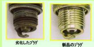
点火プラグの**電極が劣化し磨耗**すると火花が飛ばなくなりますので、電極を定期的に確認し、清掃又は早めに交換しましょう！
